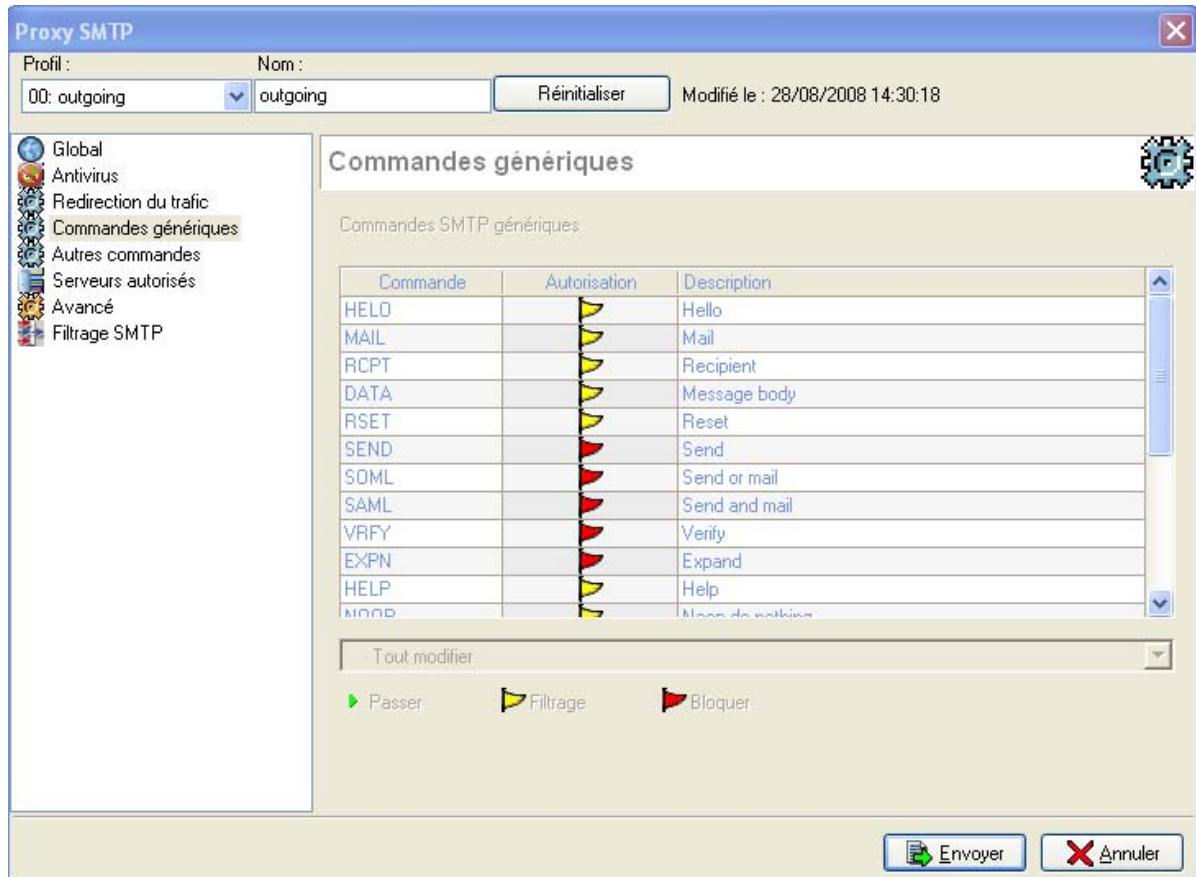
Figure 284 : Proxy SMTP - Commandes génériques
