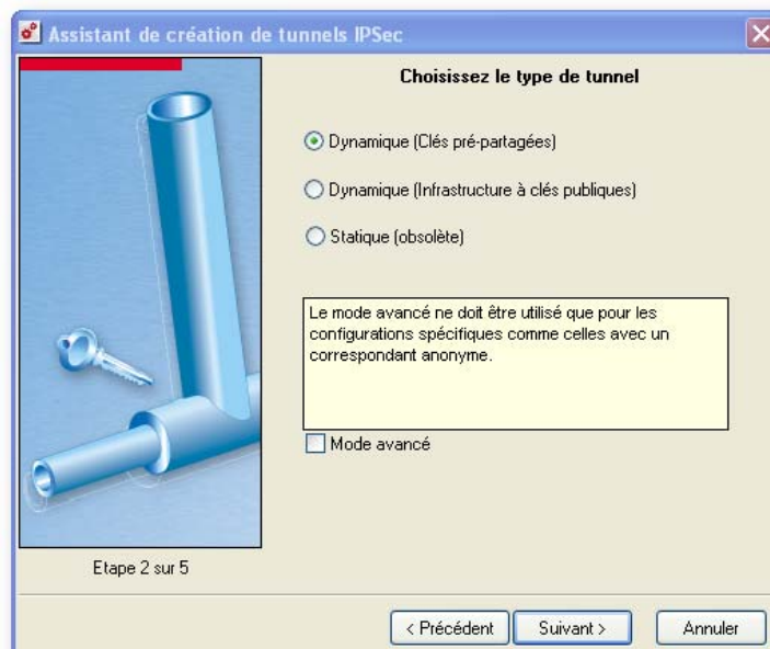
Figure 237 : Création de tunnels IPSec - Etape 2
